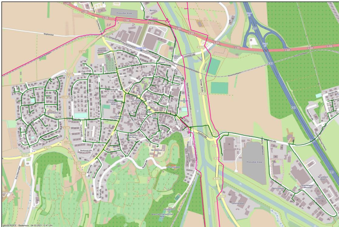
Abbildung 4 – Gasleitungen (grün) in Riegel
